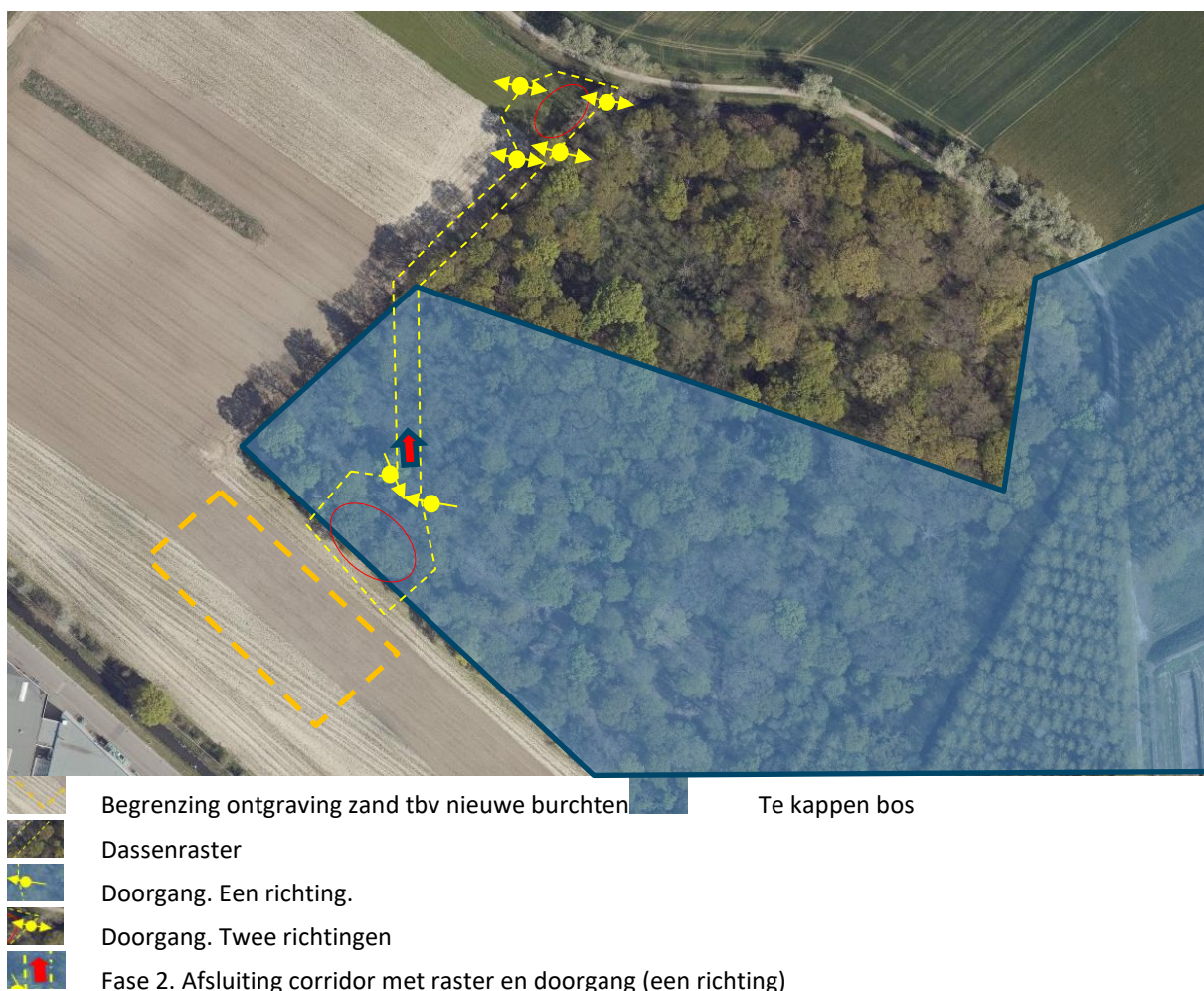
Figuur 2.7: werkvolgorde en geleiding richting nieuwe locatie.
